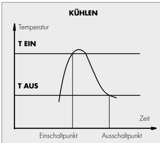
**BITTE BEACHTEN SIE:** Wenn nach der Einstellung der Ein/Ausschalt-Temperatur (Heizen) die tatsächliche Temperatur innerhalb des Temperaturfensters liegt (z. B. das Relais soll bei Unterschreiten von 20°C einschalten und bei 25°C wieder ausschalten und die aktuelle Temperatur beträgt 23°C), zieht das Relais nicht an. Erst wenn die Temperatur unter 20°C fällt, schaltet das Relais ein und fällt bei Erreichen von 25°C wieder ab. Umgekehrt trifft dies auch im Bereich „Kühlen“ zu.
