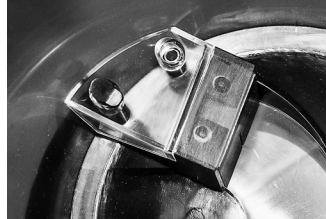
Låseplade m. låsepal in situ / Låsplatta med låshake in situ
